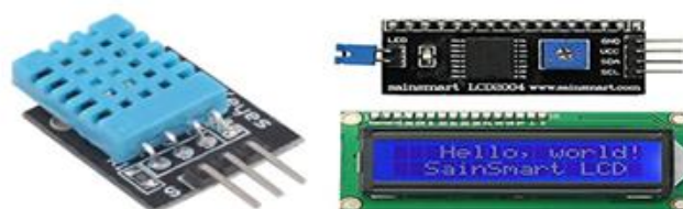
Figura 5: Sensor DHT11, Adaptador L2C e visor LCD
